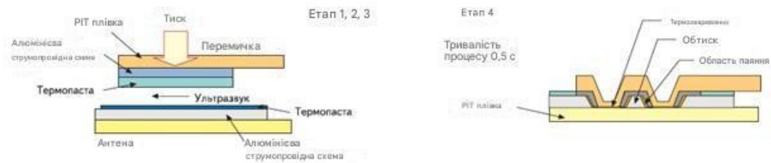
Рис. 2.5. Монтаж мікросхеми на гнучку плату
